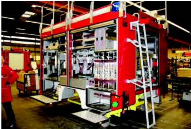
Gerätekoffer mit Löschwassertank von 1.200l Foto: Ziegler
